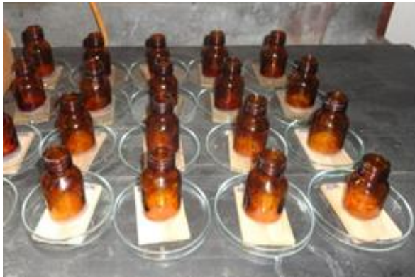
Figura 1. Recipientes de vidrio color caramelo pegadas con parafina a las probetas de madera
