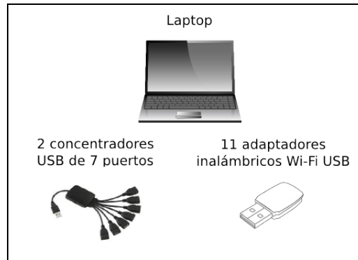
Fig. 3.3: Componentes del prototipo experimental de sniffer
