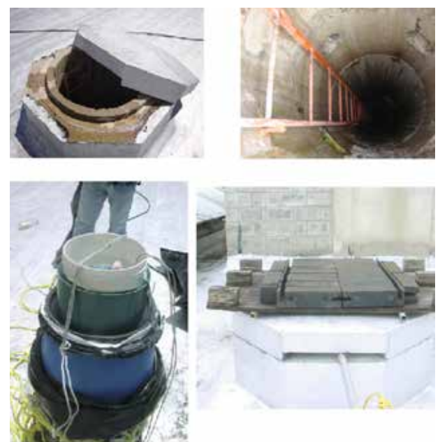
Fig 4b. Interior de la columna, detector y filtro de hierro para bajas energías
