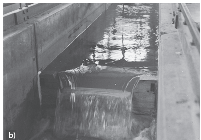
Figura 2. Descarga a máxima capacidad: a) Modelo 1V:1H aterrado y b) Modelo 1V:1/2H sin aterrado.
