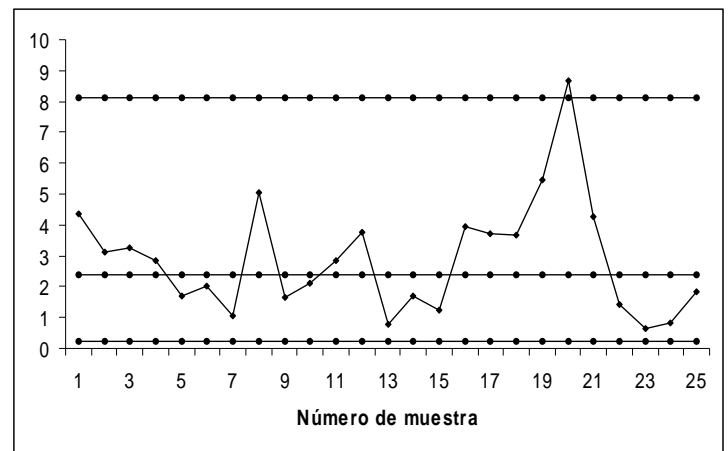
Figura 6 Gráfica de control T^2 para observaciones individuales del proceso de laminación de hojuelas de maíz (Fase I)
