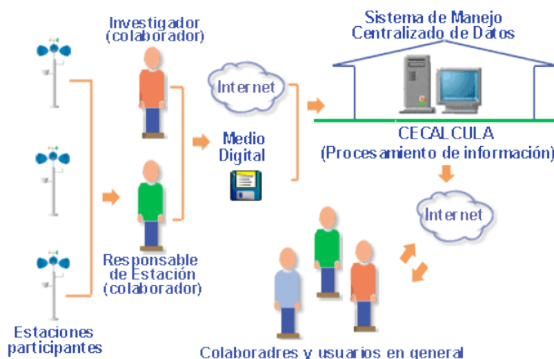
Figure 4: Esquema de procesos de envío y preservación de los datos bioclimáticos. El suministro de datos se realiza vía mensajería electrónica (correo electrónico o mensajería instantánea) o a través de envío en medios digitales ( diskette , CD, DVD)
