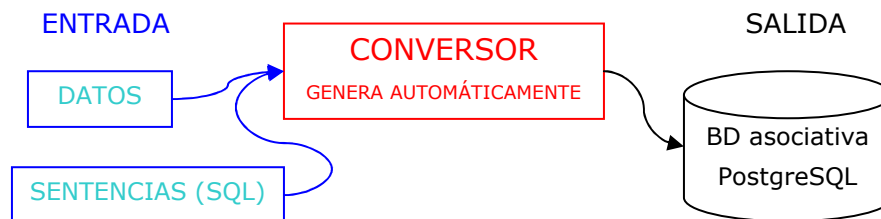
Figura 46. Esquema entrada-salida del módulo de manejo de la BD asociativa.
