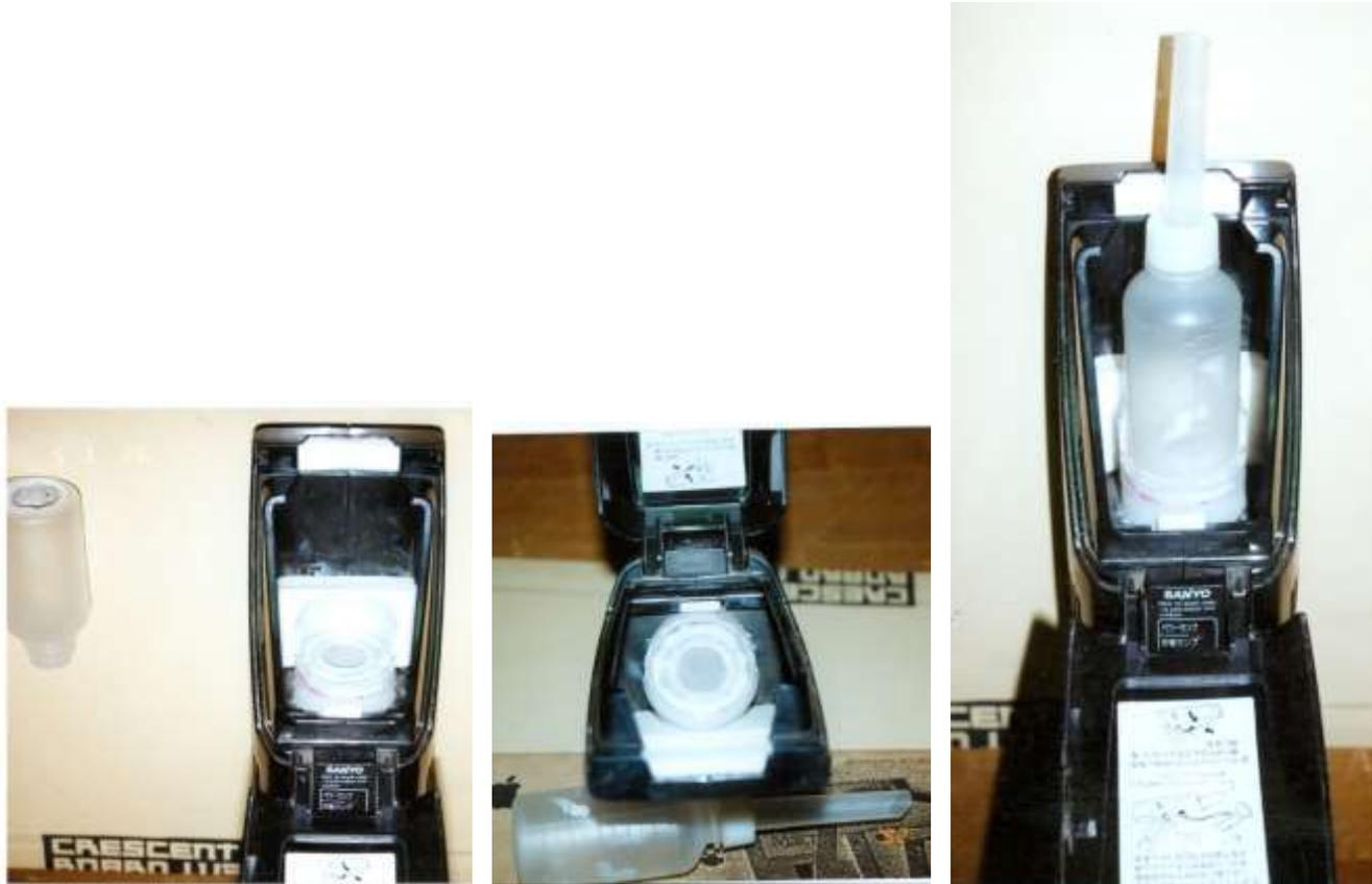
Fig. 55. Aspirador portátil a batería. El recipiente es un frasco de plástico (neoprene) al que se le eliminó el fondo, el cual se ajusta al ventilador del motor, La aspiración de los insectos se realiza a través de un tubo adaptado a la tapa del frasco. Todo está encerrado en un envase plástico (negro).
