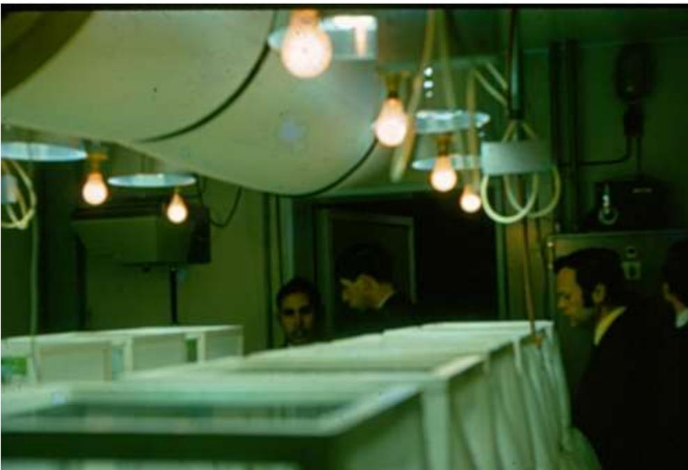
Fig. 172. Jaulas con marco de madera y paredes y techo de organdí. Iluminación artificial. La estructura tubular en la parte alta es un cilindro de tela que sirve como conductor y difusor de una corriente de aire proveniente de una bomba de aire, para mantener las jaulas aireadas.
