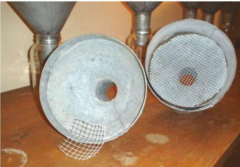
Fig. 66. Detalles de los embudos, uno con malla movable y otro con malla fija.
