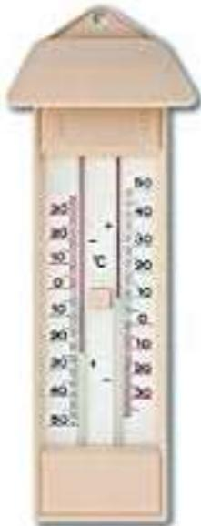
Fig. 160. Termómetro de máxima y mínima.
