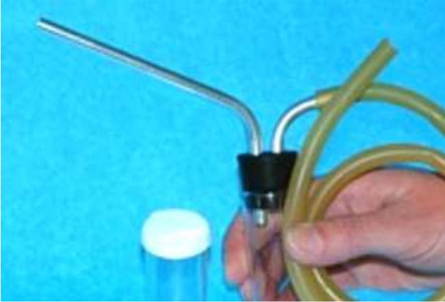
Fig. 52. Aspirador. El tubo de aspiración (pieza de boca) está a la derecha y la pieza de coleccionar los insectos está a la izquierda. Foto tomada de Keith y Moss (s. f.).
