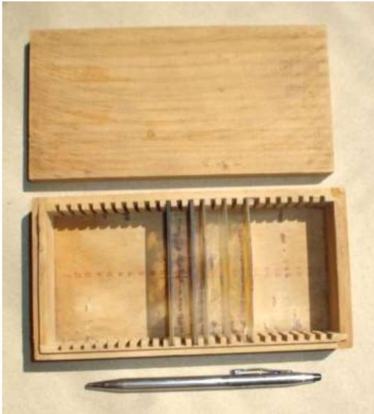
Fig. 135. Caja de madera para guardar 25 láminas portaobjetos. Cada sitio tiene un número en el fondo de la caja que se corresponde con una lista exterior, a un lado.
