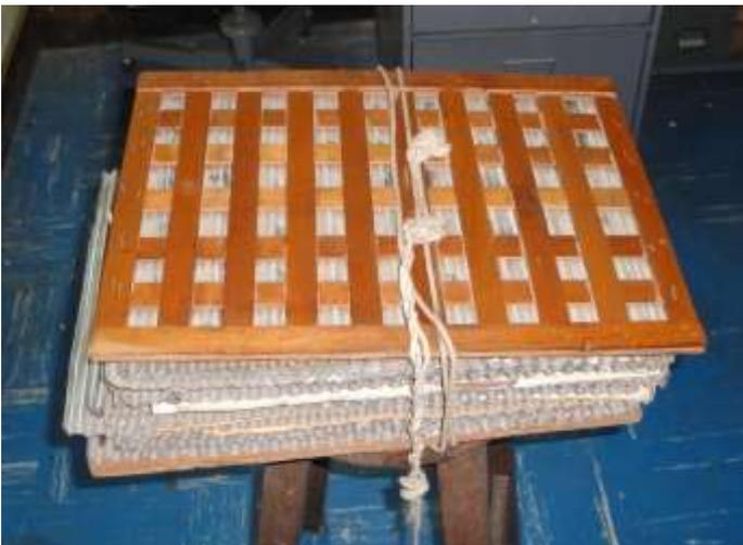
Fig. 31. Prensa botánica de madera con láminas acanaladas de aluminio.
