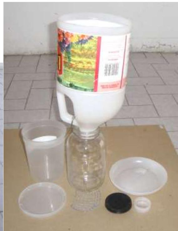
Fig. 68. Embudo de Berlese/Tullgren hecho de un envase plástico de detergente (foto a la izquierda) , cortado por su base, una malla de metal galvanizado y un frasco de vidrio o un
