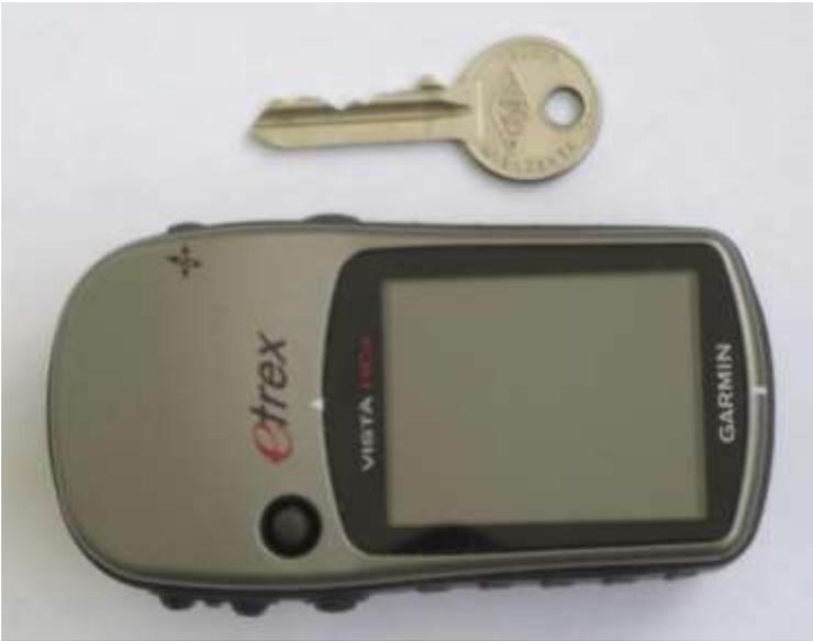
Fig. 159. Aparato de GPS para ubicación exacta de las coordenadas geográficas o UTM de un sitio, así como si altitud, aparte de muchas otras funciones y utilidades.
