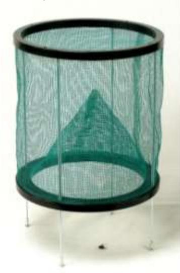
Fig. 83. Trampa para emergentes. Los insectos vuelan hacia arriba y después de pasar el cono, no pueden escapar. Este tipo de trampa se puede usar (con flotadores y anclaje) en la superficie del agua para atrapar insectos acuáticos, emergentes. Tomado del catálogo Bioquip.
