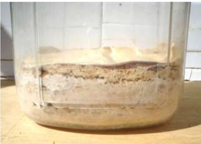
Fig. 51. Detalle de la capa de yeso y del cartón con orificios.
