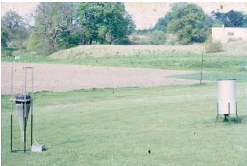
Fig.90. Trampas de succión. A la izquierda: de cono abierto y motor en la parte superior. A la derecha: de cono encerrado y motor en la parte inferior.
