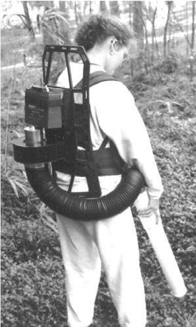
Fig. 57. Aspiradora a motor, utilizando el tubo de succión de una asperjadora. Tomado del catálogo Bioquip.
