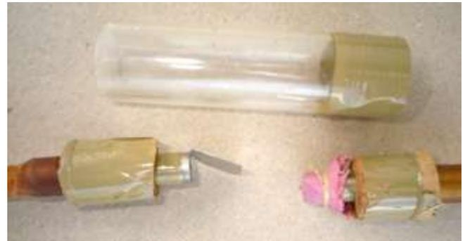
Fig. 53. Aspirador. El tubo de aspiración (pieza de boca) está a la derecha y la pieza de coleccionar los insectos está a la izquierda.
