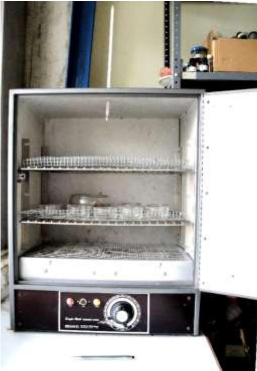
Fig. 150. Estufa con termostato para control automático de la temperatura.
