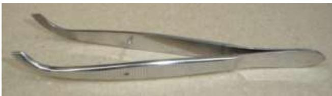
Fig. 112. Pinzas Akhurst que tienen puntas anchas, en ángulo y por dentro son ranuradas para permitir mejor agarre y manejo al montar ciertos tipos de insectos. Ideales para insertar el alfiler en insectos con alas plegadas y para montar el alfiler en el fondo la caja.
