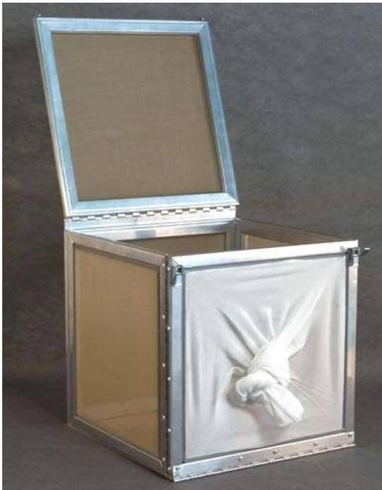
Fig. 165. Jaula de metal y malla metálica, con tapa en la parte superior para introducir objetos grandes. El frente es de tela con manga para introducir alimentos, etc., o para manipular los insectos. Tomado del catálogo Bioquip.
