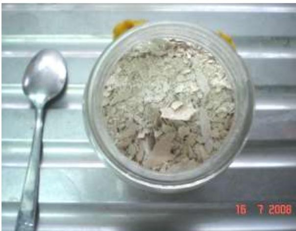
Fig. 148. Paradiclorobenceno. Hojuelas que se evaporan directamente, al igual que la naftalina. Es muy útil para control de plagas en ambientes cerrados (desde cuartos hasta closets, gabinetes, baúles, archivadores, gavetas, etc.).
