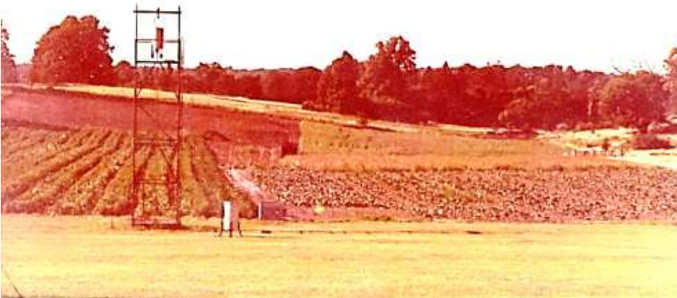
Fig. 92. Trampas de succión. Sobre el suelo: trampa de cono encerrado y motor en la parte inferior. Sobre un andamio o torre, a 10 m de altura: trampa de cono expuesto, y motor en la parte superior.
