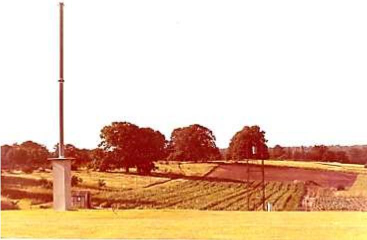
Fig. 91. Trampa de succión. Entrada de insectos a 10 m de altura, motor en la parte inferior. Se sostiene con alambres que van desde la parte más alta y de la parte media hasta el suelo. Al centro del campo se observa un andamio o torre de metal con una trampa de succión de cono encerrado en su parte más alta (10 m).
