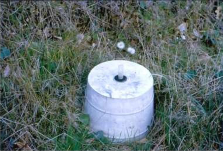
Fig. 82. Trampa para emergentes. Todo el interior está oscuro, los insectos emergentes buscan la luz y van hacia el tubo de vidrio.
