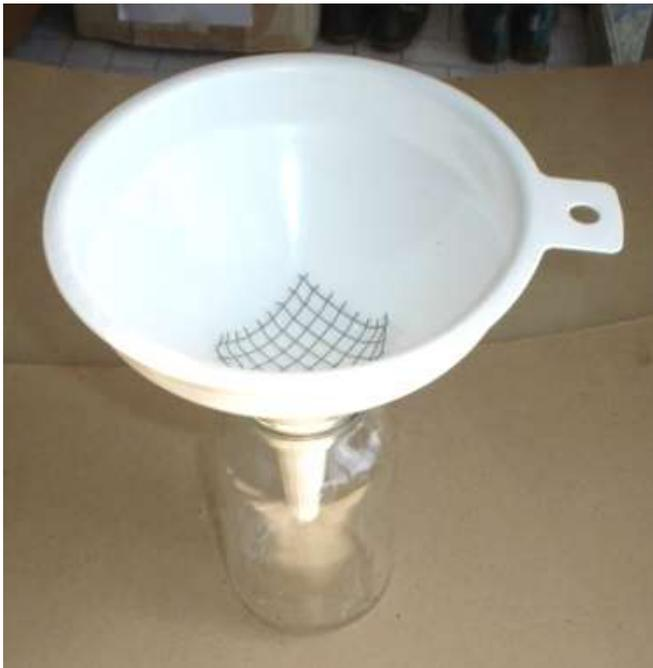
Fig. 64 Embudo de Berlese/Tullgren hecho de un embudo plástico, una malla de metal galvanizado y un frasco de vidrio. Sobre el embudo se coloca un bombillo de 100 W.
