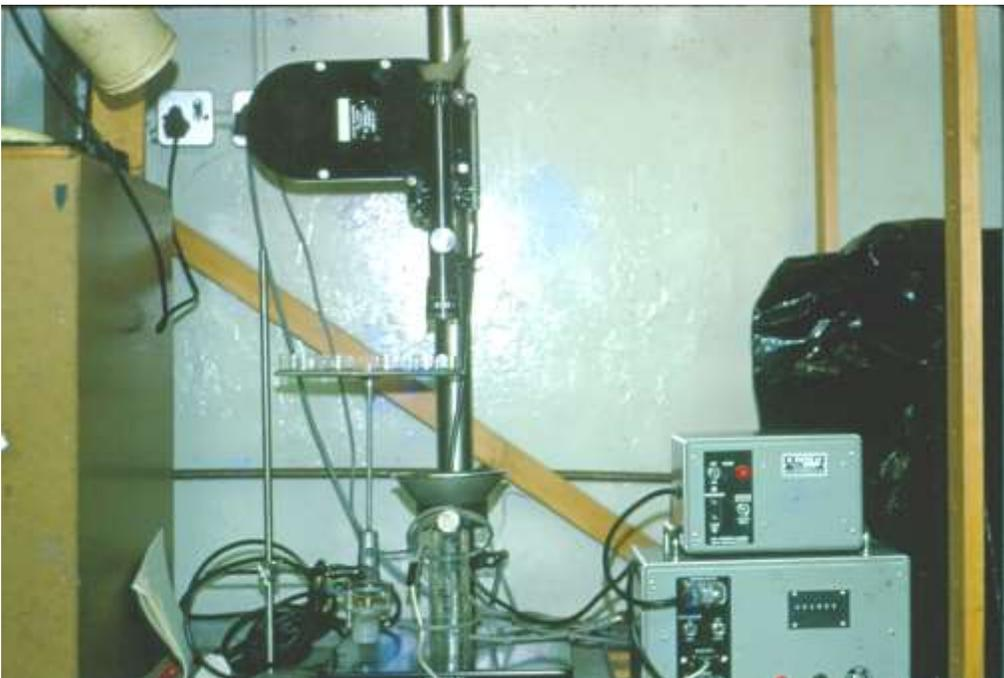
Fig. 185. Equipo de filmación cuadro por cuadro (time lapse), para estudio de desarrollo o comportamiento de insectos. La cámara arriba, al medio la bandeja que sostiene las cajas con los insectos objeto del estudio. Abajo a la derecha, los aparatos de programación del equipo.
