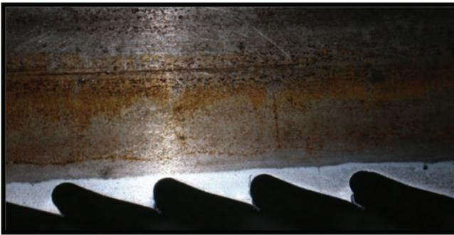
**Figura 9.** Cromado duro por electrólisis sobre Sierras de Cintas para el aserrado de la madera.
