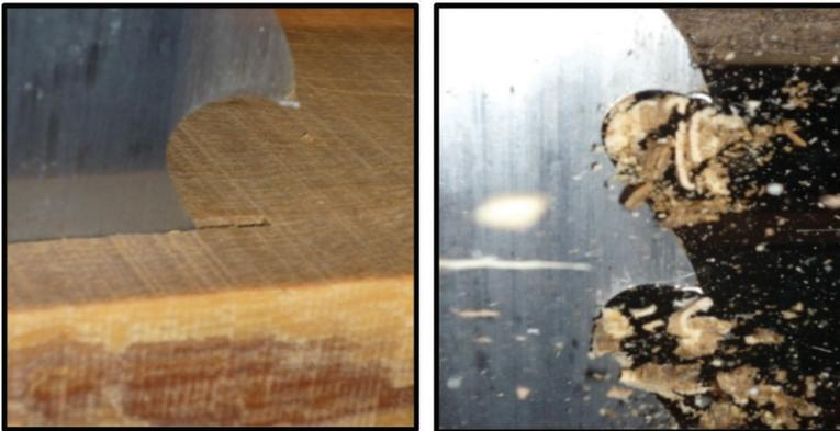
**Figura 4.** Izquierda: diente enfrentando el corte (altos impactos por la velocidad de la herramienta y la dureza de la madera). Derecha: dientes evacuando las virutas luego de realizar el corte (fricciones y temperatura producto de la mayor o menor abrasividad de la madera).
