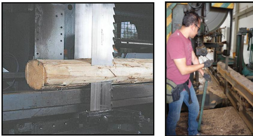
**Figura 1.** Aserrado de madera empleando una sierra de cinta doble vertical (izquierda) y sierra de cinta single (derecha).
