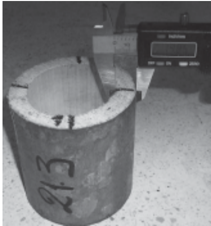
Figura 1. Medición de espesor de pared de las probetas
