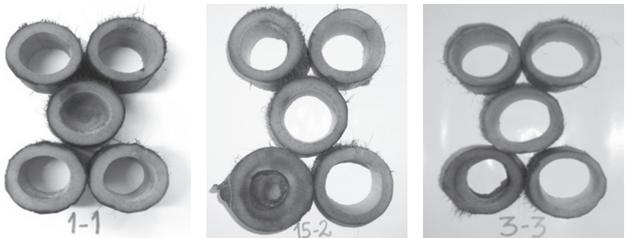
Figura 4. Penetración total irregular y total regular conseguida en culmos tratados por el método de difusión simple sin cutícula.
