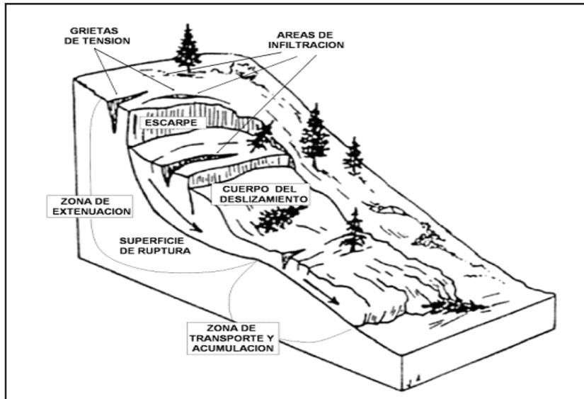
Figura 6. Esquema de un deslizamiento rotacional ideal
