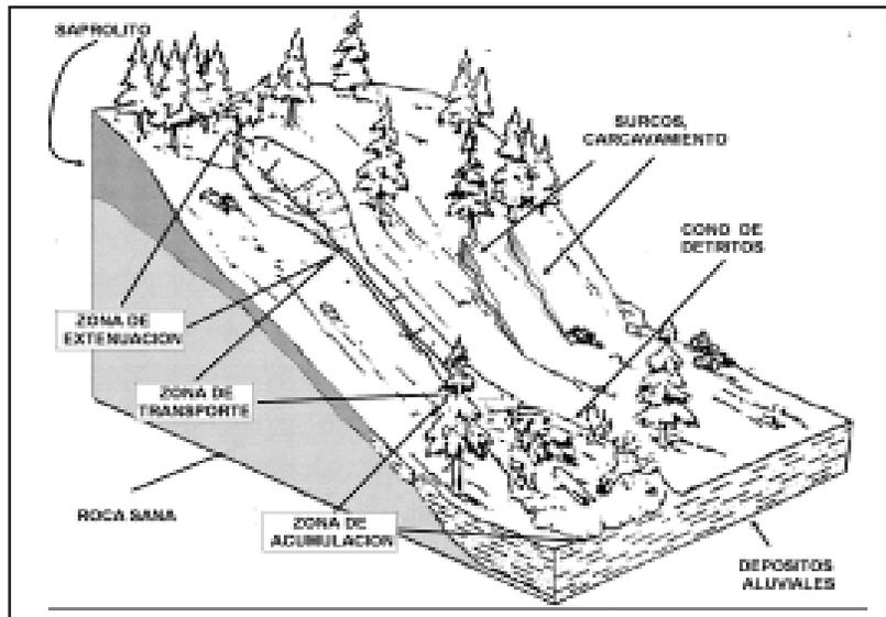
Figura 4. Esquema de un flujo de detritos ideal
