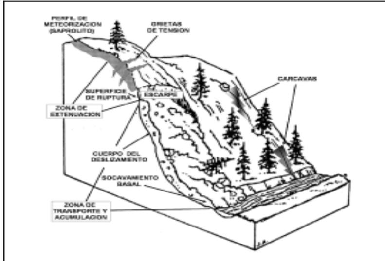
Figura 5. Esquema de un deslizamiento trasnacional ideal
