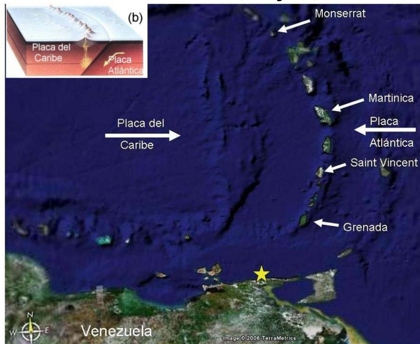
Figura 1: Arco insular de las Antillas Menores. Las flechas gruesas indican el movimiento relativo de las placas del Caribe y Atlántica, responsable de la zona de subducción que existe en la región y que da origen a la cadena de islas volcánicas.
