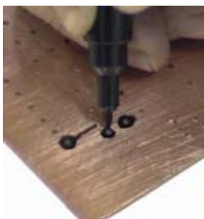
Figura 1. Elaboración de PCBs mediante ataque químico utilizando el método Manual o Artesanal.
