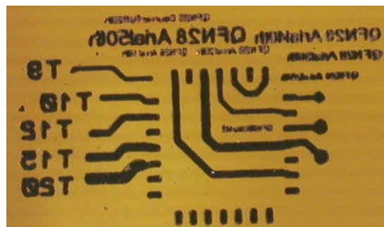
Figura 6. PCB elaborado con papel transfer
