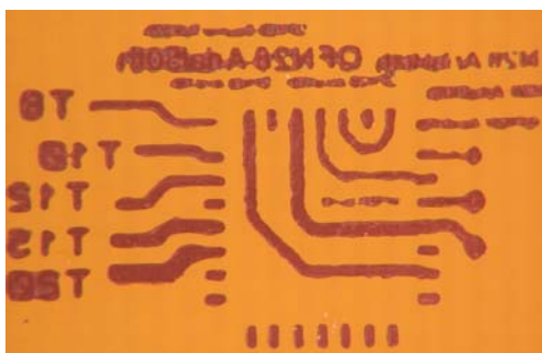
Figura 5. PCB elaborado por Tarjeta Sensibilizada.
