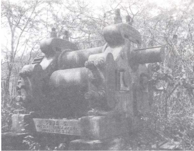
Foto 3: Caldera, máquina de vapor “Deutz” y mazas tipo “Cuba C”, fabricadas en The Geo L. Squier MFC Co., Buffalo, N Y., U.S.A. Sogoré, Edo. Lara
